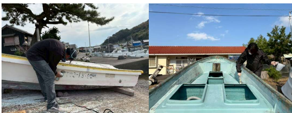
割れている部分を削り取る
