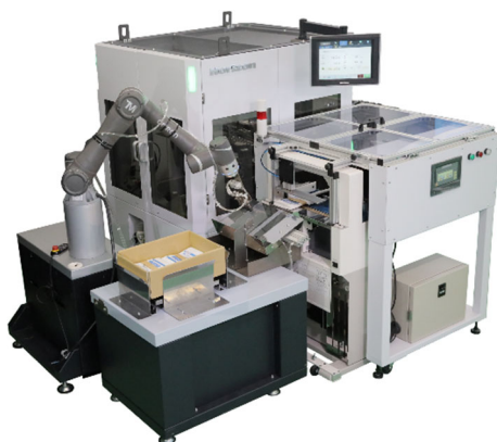
図 2-24 工程最終段における協働ロボットの活用例（箱詰め工程）
