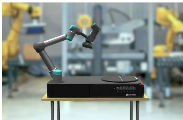
図 2-25 3次元測定における協働ロボット活用例（AM 分野）
